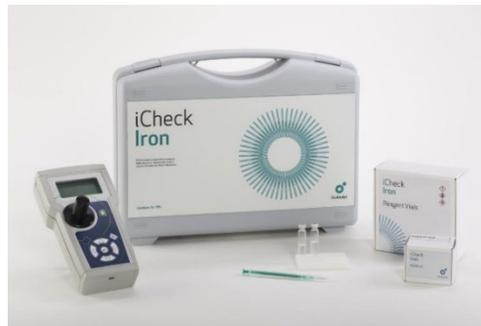
Un environnement acide réduit le fer ferrique ( $\text{Fe}^{3+}$ ) en fer ferreux ( $\text{Fe}^{2+}$ ), qui réagit avec la bathophénanthroline. Le complexe rouge de fer et de bathophénanthroline ainsi obtenu est corrélé à la concentration en fer et est mesuré à 525 nm avec l'appareil iCheck. La plage de mesure de l'iCheck Fer est comprise entre 1,5 et 12,0 mg/L.
